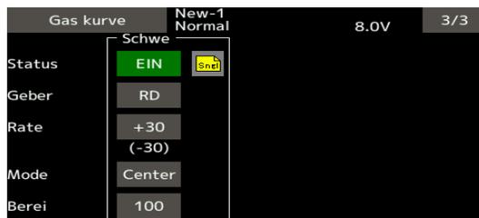
Die Funktion Motor/Gas Schwebeflug sorgt für die Gas-Trimmung im Bereich des Schwebepunkts. Normalerweise sollte sie für Schwebepunkte verwendet werden. Änderungen der Rotorgeschwindigkeit bei gleichzeitiger Änderung von Temperatur, Feuchtigkeit oder sonstiger Flugbedingungen lassen sich trimmen. Motor/Gas so einstellen, dass die Rotorgeschwindigkeit am stabilsten ist. Eine feinere Trimmung ist auch möglich, wenn man diese Funktion mit der Schwebepitch-Funktion kombiniert.
