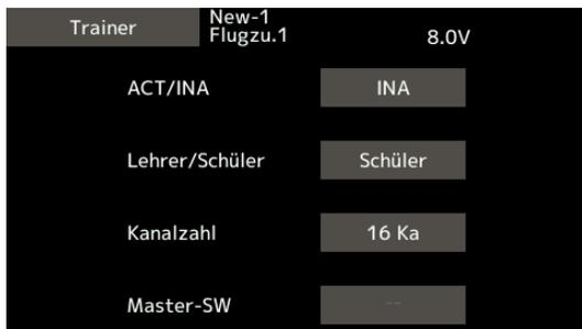
Bei einer Verbindung zwischen Lehrer und Schüler mittels Kabel erfolgt die Spannungsversorgung des Schülers über dieses Kabel und wird beim Anstecken automatisch eingeschaltet (Schalter bleibt auf AUS). Sind die Spannungen von Lehrer und Schüler unterschiedlich (8 NiMH ↔ 2 S LiPo/ LiFe) wird das beschriebene Konverterkabel P-TC-SQ7-2 verwendet.
