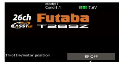
Hier drücken um den Alarm abzuschalten. Der Sender sendet dann nicht, es kann aber jede Programmierung "stromsparend" durchgeführt werden
