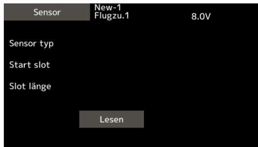
\*Es gibt Sender (z. B. T6K), die nicht mehr verwendet werden können, wenn der Startslot eines Sensors geändert wird.
