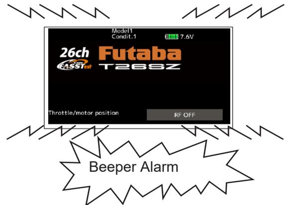
Wenn der Beeper beim Einschalten ertönt, zunächst den Gasknüppel auf Leerlauf stellen, bevor der Empfänger eingeschaltet wird. Sind Gas positionen mit einem Schalter betätigt muss der Alarm Beeper Damit abgeschaltet werden.
