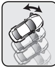
Danke, dass Sie sich entschieden haben den GYD450 Auto Kreisel zu kaufen. Kompakt und leicht. Der GYD450 wurde für die Lenkung bei RC Drift Autos konzipiert. Wenn der Sender 3 oder mehr Kanäle hat (Einstellmöglichkeit von 3 Kanälen) kann die Kreiselempfindlichkeit vom Sender aus eingestellt werden. Zu den Merkmalen gehören ein einfaches Setup und die S.BUS/S.BUS2 Anbindung.
