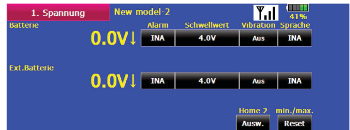
Displaydarstellung des Telemetrie Monitor und Sensormenüs im Sender T18MZ
