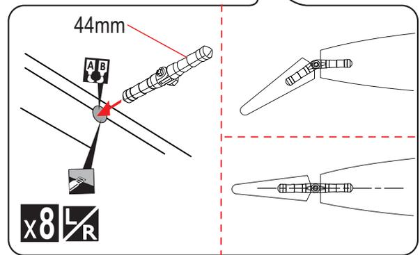
**INSTALLING THE AILERONS AND FLAPS SERVOS.**
