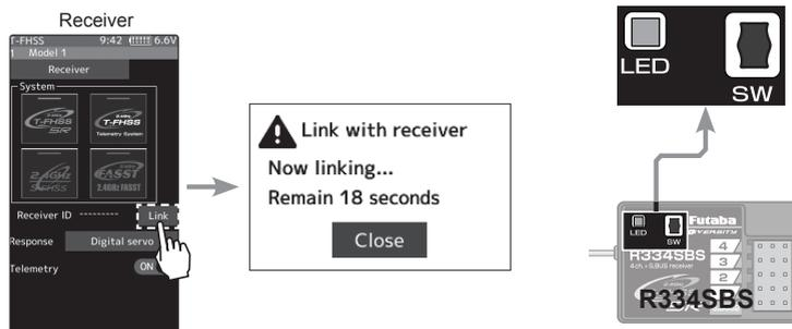
5. Während des laufenden Countdowns, am Empfänger den Link-Taster für ca. 2 Sekunden gedrückt halten, die LED beginnt abwechselnd rot - grün zu blinken und es erscheint im Sender Display die Meldung "Link with receiver". Link-Taster am Empfänger jetzt loslassen. Nach erfolgter Bindung, leuchtet die LED dauerhaft grün.
