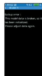
Wenn die Datenstruktur im Sender fehlerhaft ist, erscheint die Meldung BACKUP ERROR. Schalten Sie den Sender aus und erneut ein. Tritt der Fehler erneut auf, muss der Sender in den Service eingeschickt werden.
