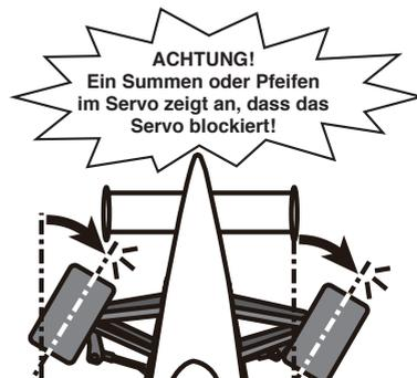
Stellen Sie den maximalen Ausschlag so ein, dass das Servo nicht mechanisch blockiert!
