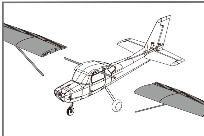
2. Fixez les mâts d'ailes au fuselage à l'aide des goupilles fournies.
